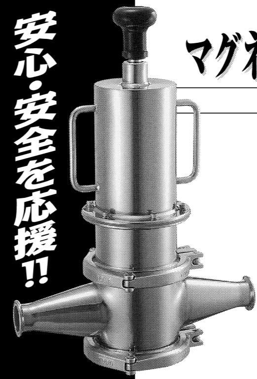
水洗のとき直角部コーナーに気泡が発生し、完全に洗浄できない欠点がありました。マグネットケースの外周を溶接することによりRを形成し、洗浄時の液残りがなくなり雑菌繁殖を防止します。
