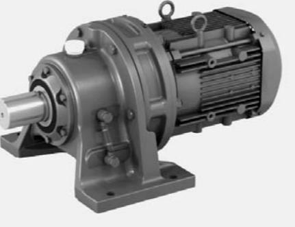
住友重機械工業と住友重機械ギヤモータは、トップランナーモーターに対応した「プレミアムギヤモータ」(写真)も発売した。この製品は、従来モーターと同一構造で取り付け互換性を確保し、絶縁信頼性向上するため、全機種の耐熱ランク(Bランク)とし、長寿命化を実現。屋外形は保護構造をIP55とし、耐環境性能を向上。端子箱の上部取り付けに対応により、複数台並列使用時の省スペース化が図られるなど。
