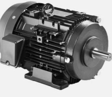
東芝のトップランナーモーター「プレミアムゴールドモータ」(写真)の特徴は、①200kW級の定格全てでI E3効率を達成②従来モーターと同一構造で取り付け互換性を確保③絶縁信頼性向上するため、全機種の耐熱ランク(Fランク)とし、長寿命化を実現。屋外形は保護構造をIP55とし、耐環境性能を向上。端子箱の上部取り付けに対応により、複数台並列使用時の省スペース化が図られるなど。
