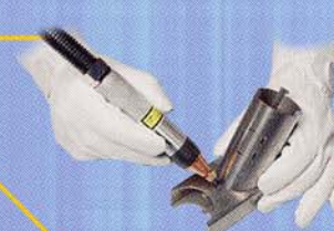
レーザハンド溶接 TruLaser Handy
