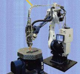
レーザ溶接ロボット TruLaser Robot
