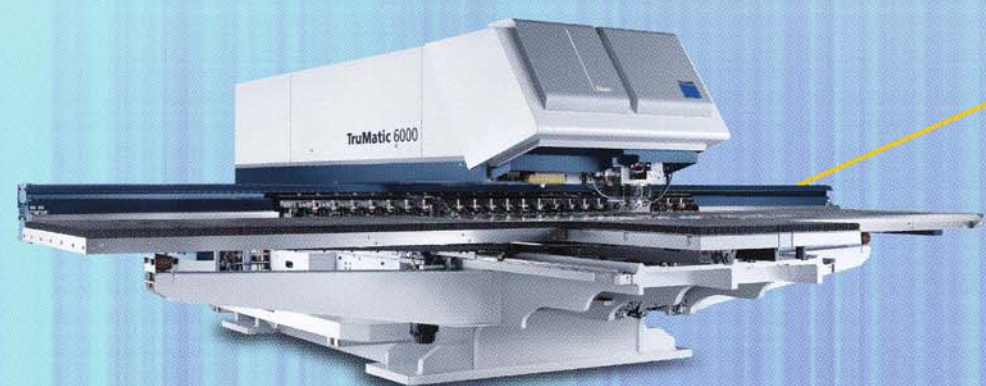
パンチレーザ複合機 TruMatic 6000 fiber
