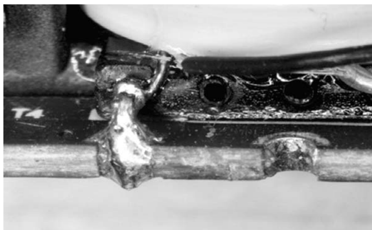
写真1 重量部品の挿入型トランス設計に課題(回路設計事例)
