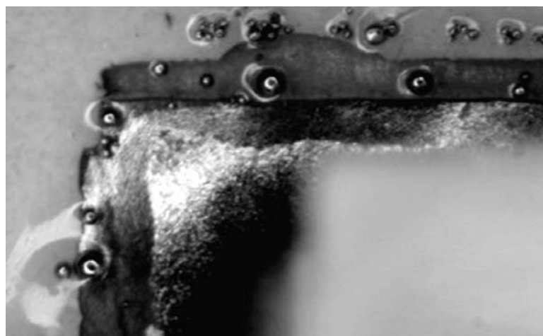
写真2 部品周辺部に比較的大きなハンダ粒を多数確認(温度プロファイル不適正事例)
