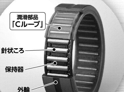
Cルーブベアリングは、軸受空間に熱硬化固体潤滑剤「Cルーブ」を充填した軸受です。軸受が回転することで、潤滑剤が軌道面に常に適量しみだし、長期にわたってメンテナンスフリーを実現しています。このCルーブベアリングは、油を嫌う用途やメンテナンスできない箇所での使用に最適です。
