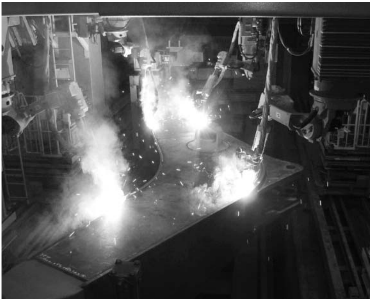
①油圧ショベルのブームを溶接する(コマツ)②エネルギー開発の現場で活躍するタダノのラフテレーンクレーン(写真はカナダのモジュールヤード)
