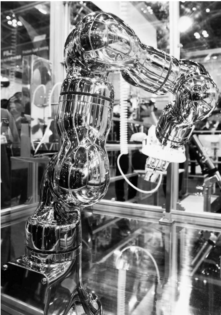
川崎重工工業のステンレスロボットによる電子部品組み立てシステム
