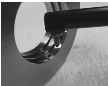
狭い溝にも入る小径ロングタイプのバリ取りカッター
