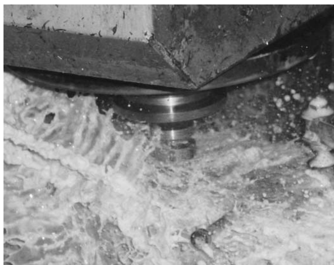
アクワオイルME10Nを使ったSKH51の直径1mmの深穴加工
