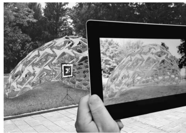
タブレット端末のカメラ画像に設計データのデジタルモデルを重ねて表示(大林組・東京大学デジタルファブリケーションラボ)
