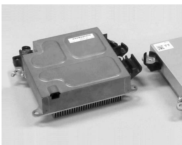
TDKが開発した新型DC/DCコンバーター(右)は従来品(左)に比べ体積を半分にした
