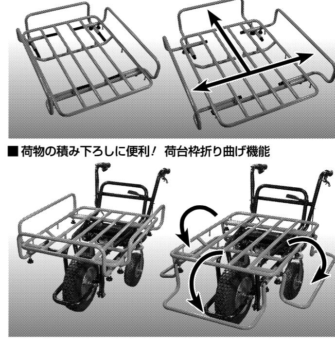
■サイズ:132x74x78cm ■重量:52kg(バッテリー含む) ■最大速度:3km/h ■最大積載量:120kg ■最大走行可能斜面:12度 ■バケット荷台容量:116リットル ■バイブ荷台面積:87x66cm(折り曲げ式) ■後輪幅可変式:42~65cm ■バッテリー:DC24V 鉛蓄電池 ■電池残量表示計&過電流保護回路付き ■連続使用時間:3時間 ■最小回転半径:50cm ■材質:低炭素鋼フレーム ■前輪タイヤ(1個、外径40cm、空気タイヤ)、後輪タイヤ(2個、外径25cm、ノーパンクタイヤ)
