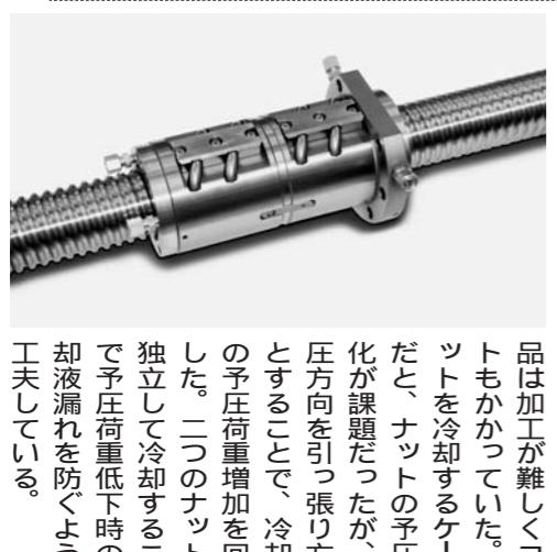
日本精工が開発した「ダブルナット冷却ボールねじ」は、ナット部に冷却機構を設けており、冷却加工の自動化を可能にしています。金型の切削するツール、金型の切削・研削加工に用いた数値制御(NC)工作機にそ
