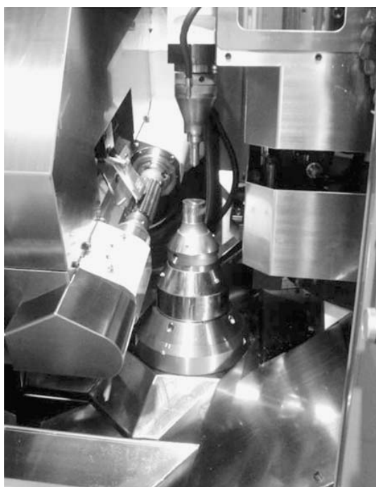
写真2 ドライ加工用ホブ盤の切りくず処理対策(三菱重工業提供)
