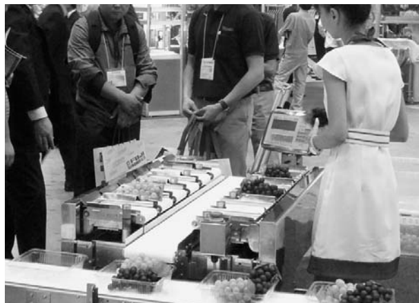
産業社会で多様な計量器が活躍。重量にバラ付きのある食品を組み合わせて定量にする装置(大和製衡)
