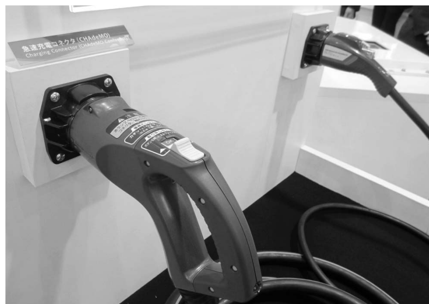
電気自動車（EV）電源への急速充電用コネクタ（手前）とEV電源から電気を取り出すV2H用コネクタ（奥）（10月18日、第20回ITS世界会議東京2013の展示会で）
