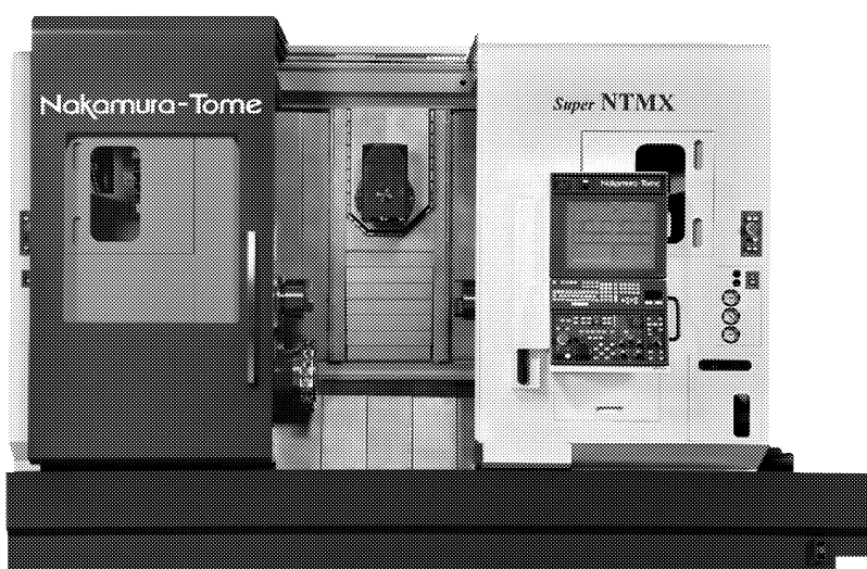
図1 2ツールマガジン複合加工機「Super NTMX」 (中村留精密工業：Webページより)
