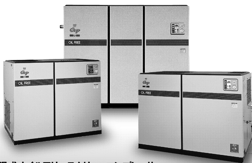
水潤滑式オイルフリースクロールコンプレッサ 主電動機出力: 15~75kW 吐出空気量: 0.7~12.7m³/min
