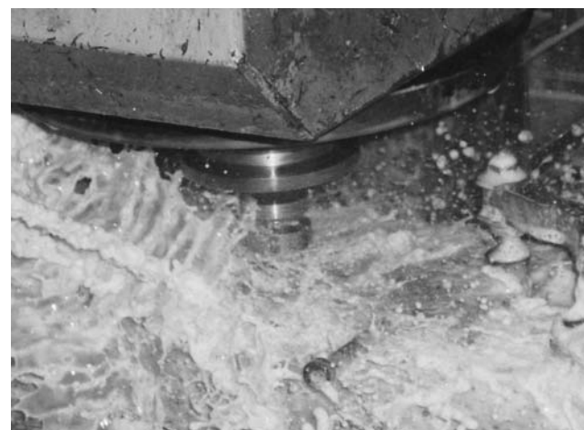
アクワオイルME-10Nを使ったSKH51の直径10mmの深加工
