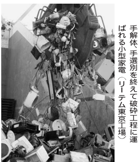
手解体手選別を終えて破砕工程に運ばれる小型家電(リーデム東京工場)
