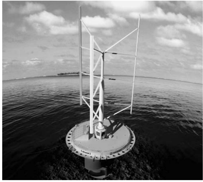
潮流と風力を組み合わせた洋上発電装置(設置イメージ)
