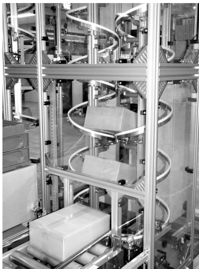
らせんの働きで荷物を昇降 (第一施設工業のスパイラルリフター)
