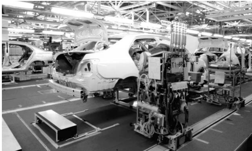
台車に載せて車を搬送する生産ライン
