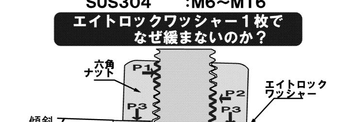
エイトロックワッシャーの座面傾斜の働きで、ねじのP1、P2方向に応力が発生します。P1、P2の内部応力とP3の座面にかかる応力の合成で高い緩み止効果を発揮します。荷重が分散されるので焼き付きを防ぐことができます。
