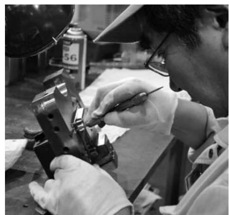
金型に複雑な細工を施して、最適な温度コントロールを行う(岩機ダイカスト工業)
