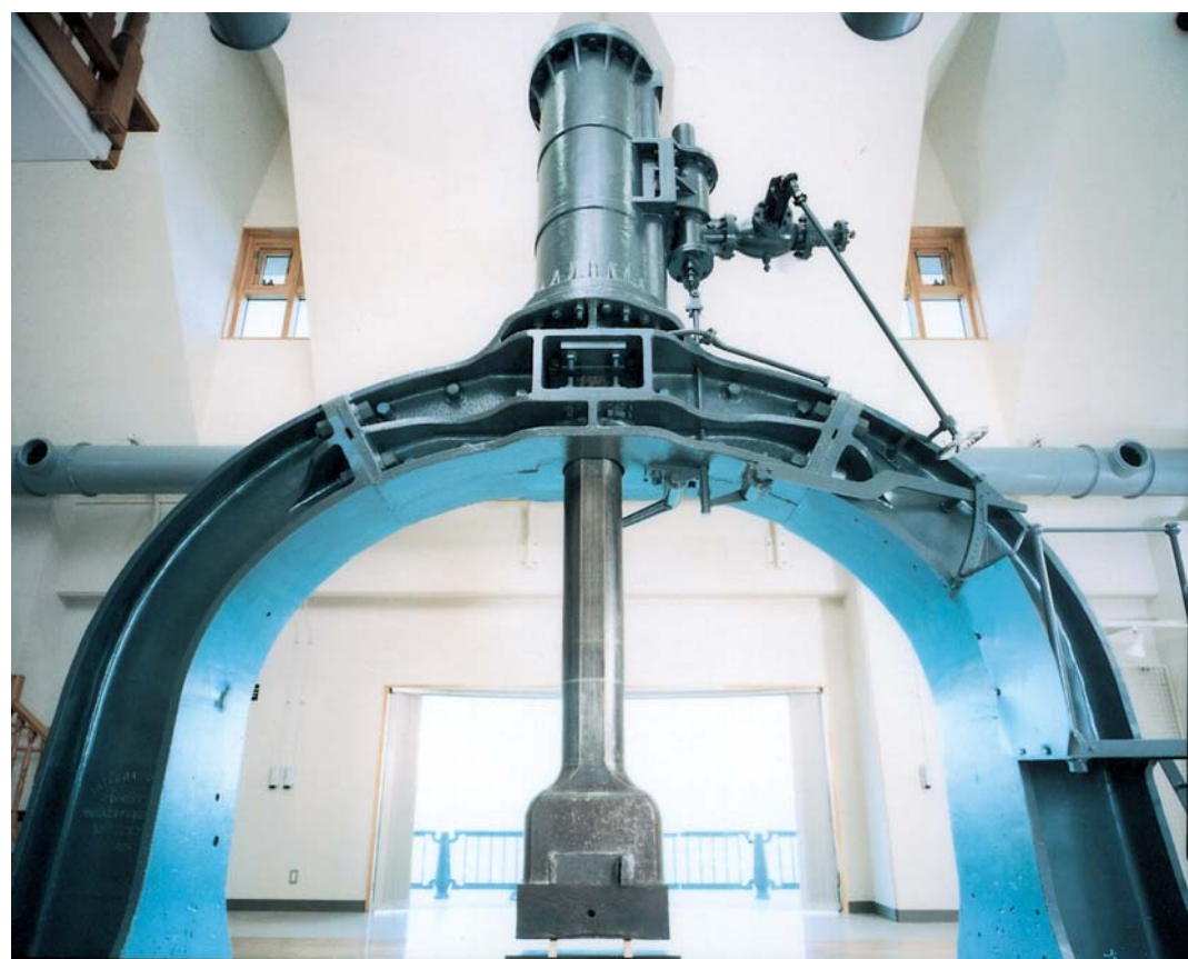
国指定重要文化財の「横須賀製鉄所・1865年オランダ製3トン門形スチームハンマー」。日本の鍛圧機械の原点ともいえる。 (写真提供・横須賀市自然・人文博物館)
