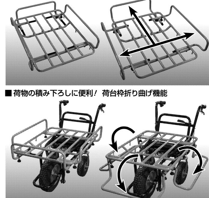
■サイズ:132x74x78cm ■重量:52kg(バッテリー含む) ■最大速度:3km/h ■最大積載量:120kg ■最大走行可能斜面:12度 ■バケット荷台容量:116リットル ■バイブ荷台面積:87x66cm(折り曲げ式) ■後輪幅可変式:42~65cm ■バッテリー:DC24V鉛蓄電池 ■電池残量表示計&過電流保護回路付き ■連続使用時間:3時間 ■最小回転半径:50cm ■材質:低炭素鋼フレーム ■前輪タイヤ(1個、外径40cm、空気タイヤ)、後輪タイヤ(2個、外径25cm、ノーベンクタイヤ)
