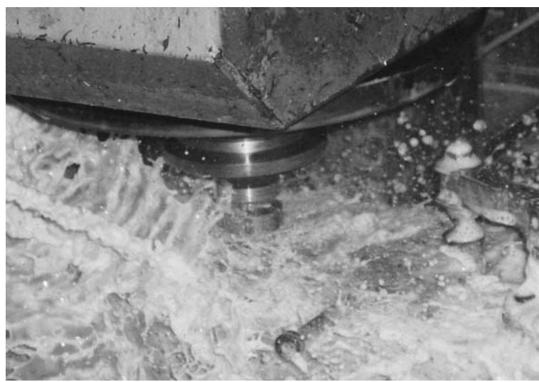
アクワオイルME-10Nを使ったSKH51の直径1mmの深穴加工
