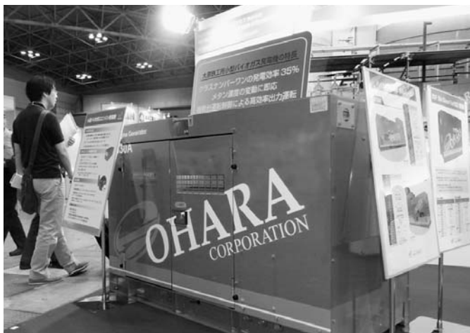
大原鉄工所のバイオガス発電機は発電効率35%を実現
