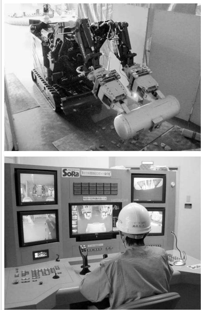
東京電力福島第一原子力発電所の建屋内作業支援用の小型双腕重機型ロボット⑤と遠隔操作盤⑥(日立パワーソリューションズ提供)
