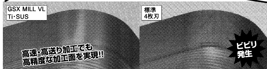
図1 GSX MILL VL Ti-SUS加工事例 Ti6Al4Vポケット加工
