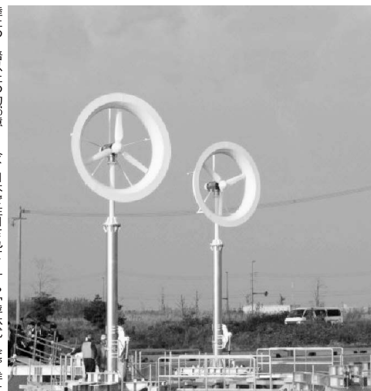
九州大学が博多湾に設置、実証実験を行っている「風レンズ風車」(九大提供)
