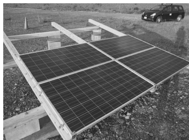
兵庫県佐用町が産官連携で導入する木造架台のメガソーラー（試作モデル）
