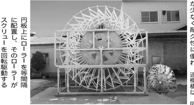
日本上にローラーを等間隔に配置し、そのローラーがスクリューを回転駆動する
