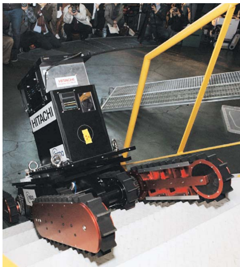
原子力発電所での利用を想定した重量計測器搭載型移動ロボット
