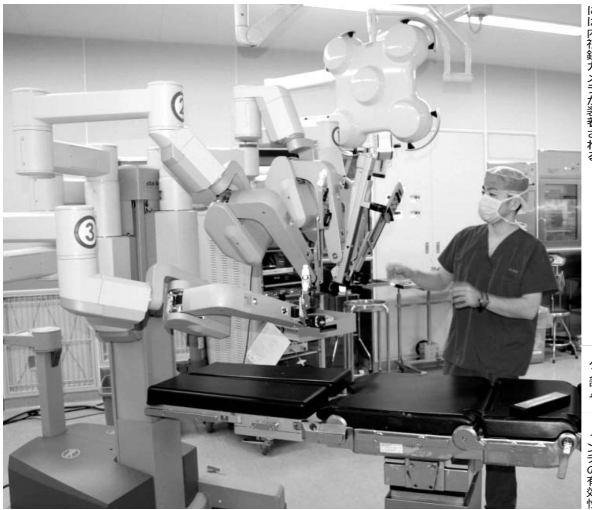
ダ・ヴィンチは米国インテコティティ・サークル社が開発したマスター・スレーブ型と呼ばれるロボット。手術を行つ医師がコンソールと呼ばれる操作台に座つて、操作台画面に映し出される3D立体映像を見ながら、体内に挿入されたロボットのアームを操作し、手術の際には4本のアームのうち3本には鉗子やメスなどが、残る1本には内視鏡カメラが装着される。
