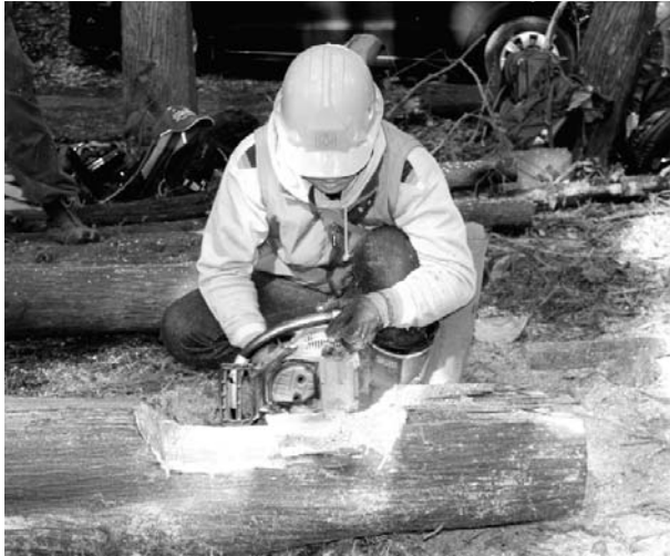
直線の加工を組み合わせてカーブも作れる
