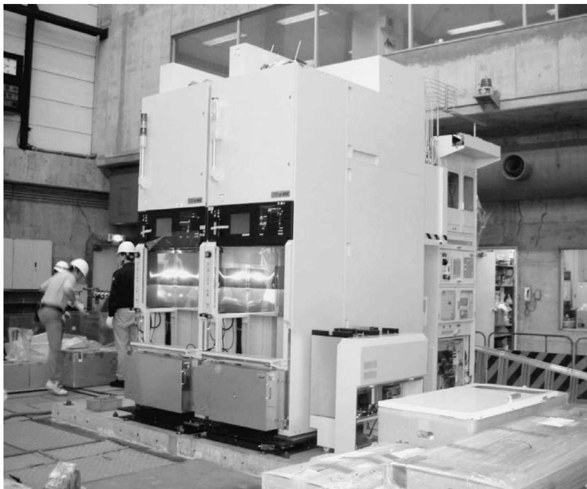
①実際の半導体製造装置を使って免震システムの性能を検証(大成建設技術センター) ②鹿島が建設した国内初の着床式洋上風力発電設備(奥が風況観測タワー)
