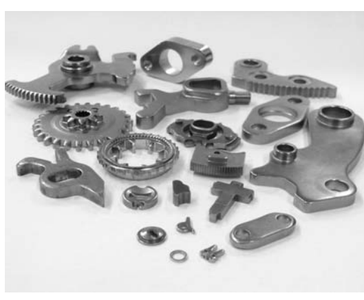
F B加工で成形された金属部品
