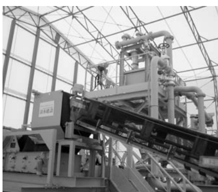
広野町で稼働した分級・洗浄処理の実証プラント(清水建設)
