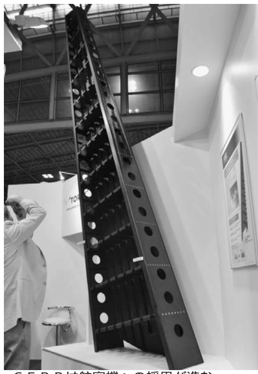
CFRPは航空機への採用が進む（東レが開発したMRJ向け垂直安定板）
