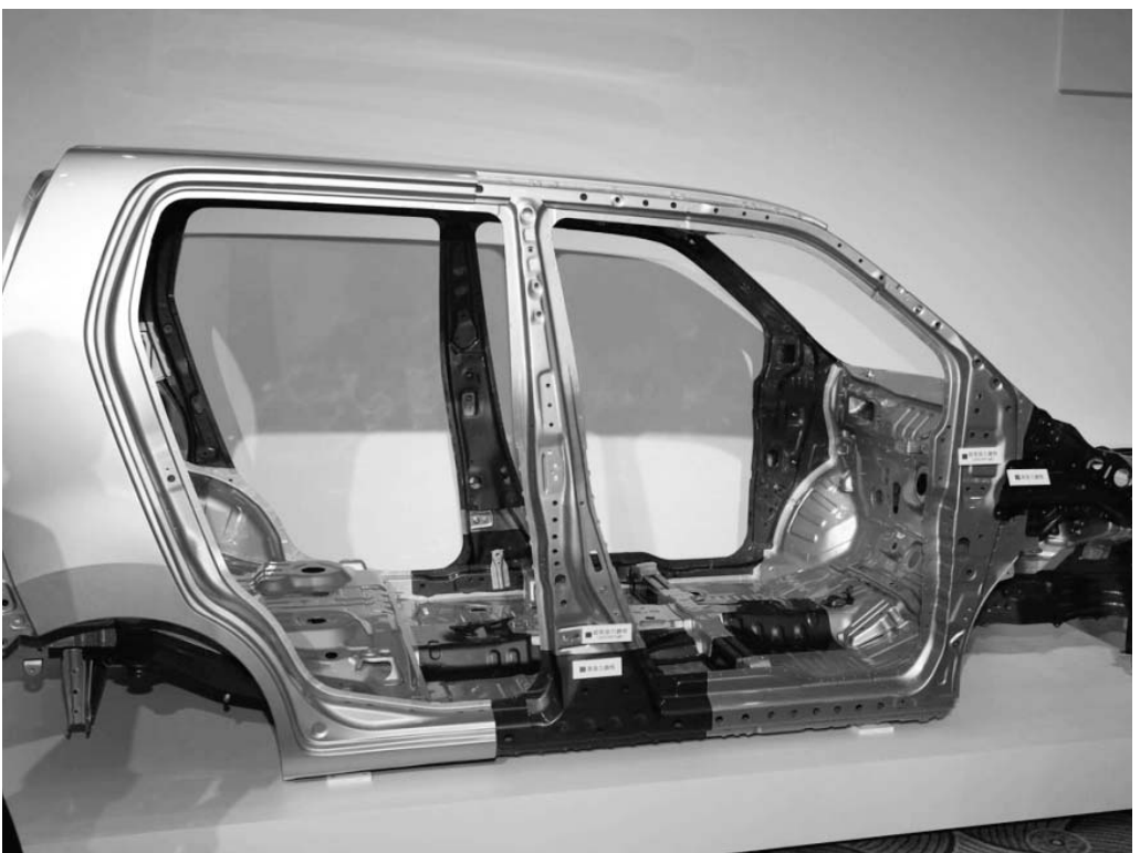
引っぱり強度980N/mm2の高級材がススキの新型ワゴンRの一部に使われた
