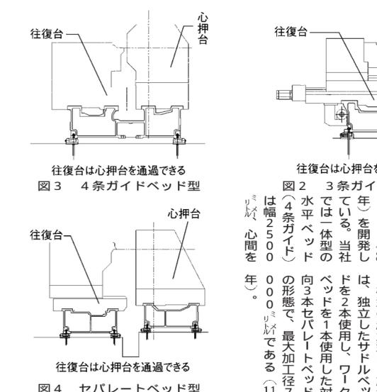
3/4条ガイド型 往復台の長手方向移動時に心押台、振止めにか
