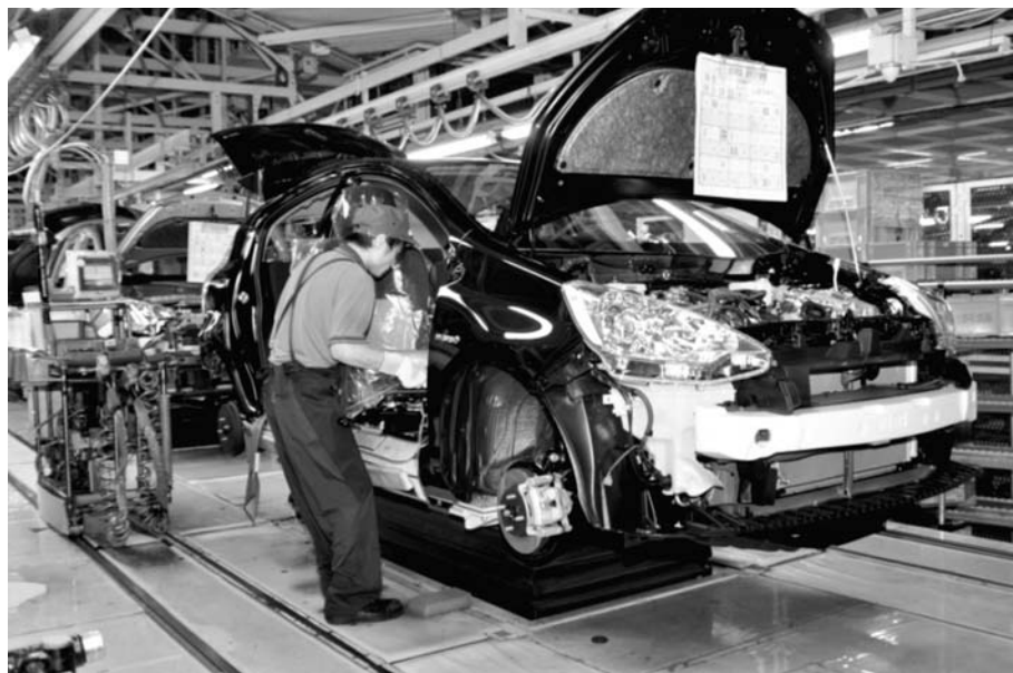
トヨタ自動車東日本岩手工場の組み立てライン。天吊りコンベヤーは使っていない
