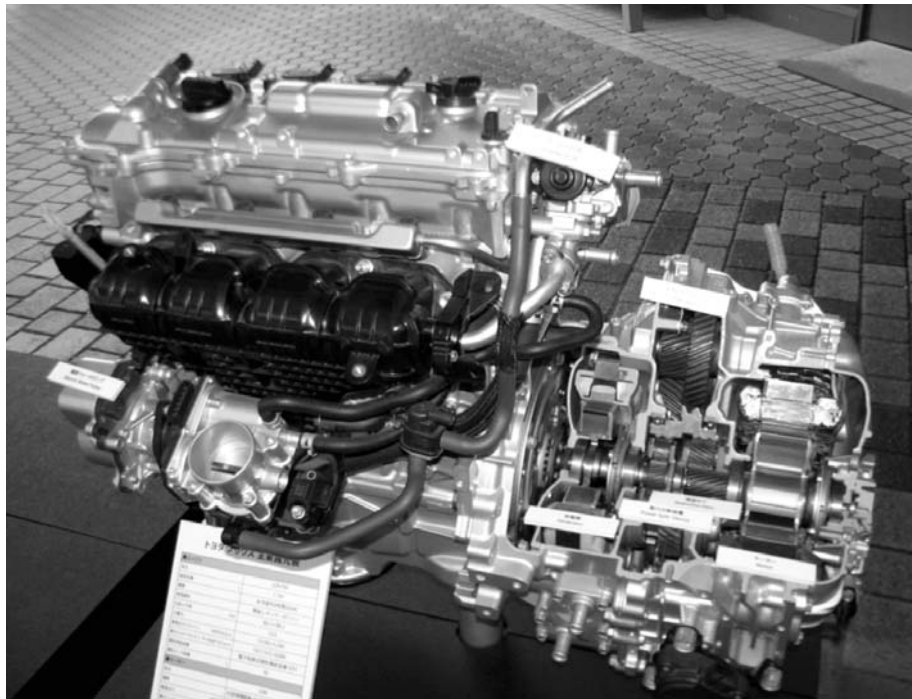
トヨタのHV技術の心臓部である「プリウス」の駆動機構
