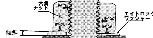
エイトロックワッシャーの座面傾斜の働きで、ねじのP1、P2方向に応力が発生します。P1、P2の内部応力とP3の座面にかかる応力の合成で高い緩み止効果を発揮します。荷重が分散されるので焼き付きもしにくい。
