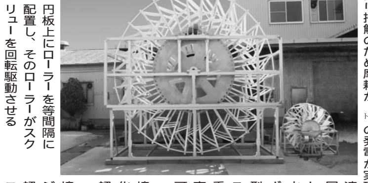
内板上にローラーを等間隔に配置し、そのローラーがスクリューを回転駆動させる
