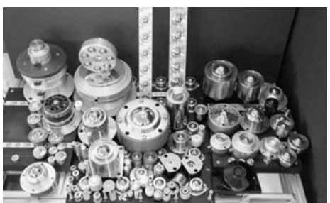
韓国で量産するボルトトランスファ(井口機工製作所)
