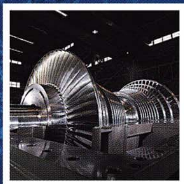
■熱・流体技術 熱を効率的に電気に変換する 発電用タービン
