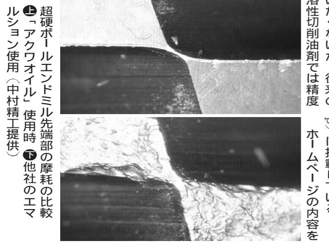
超硬ボールエンドミル先端部の摩耗耗材
