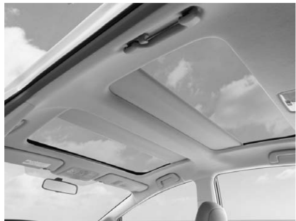
ハイブリッド車のパノラマ ルーフに採用されたポリカー ネット(トヨタ自動車提供)
